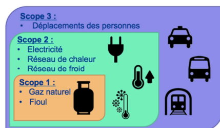
Découpage des émissions de gaz à effet de serre de l'exploitation d'un actif
